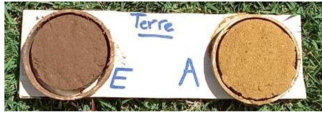
Les deux échantillons présentent un retrait au séchage. Ce dernier est plus important sur l'échantillon de Vert Pré. Au vu des éléments observés précédemment, on peut supposer ici la présence d'argile gonflante.
